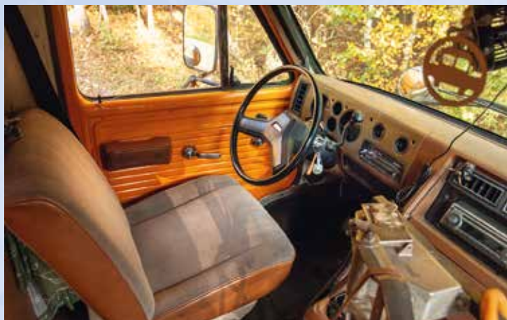
Oproti standardní G30 má tato verze busu jen jednu přední sedačku a sedačka spolujezdce je nahrazená pákou pro otevírání dveří a schody
