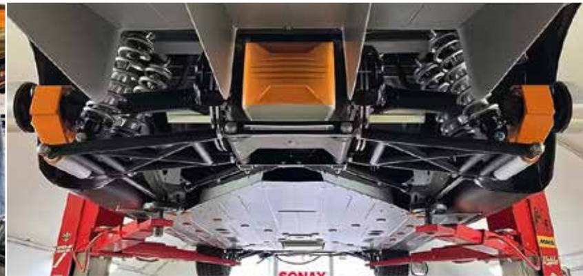
Pohled na sofistikovaný podvozek s podlahou prošípanou kandy a zakončenou difuzory vás přesvědčí, že se nejedná o běžný kustom. Zadní kotoučové brzdy mají své místo na vnitřní straně poloos u diferenciálu
