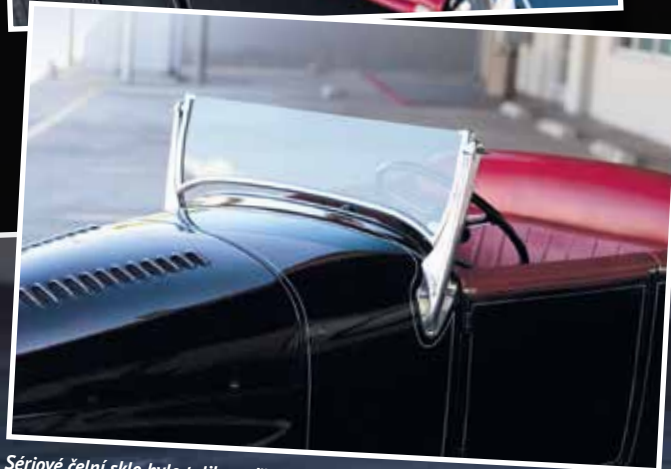
Sériové čelní sklo bylo toliko sníženo, stojí však stále kolmo proti větru
