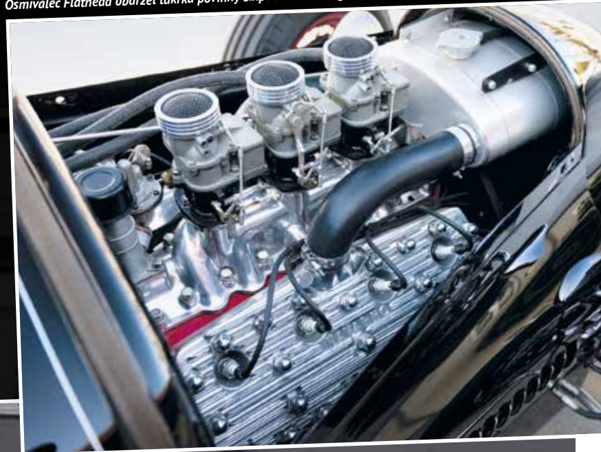
Osmiválec Flathead obdržel takřka povinný sixpack Stromberg a hlavy Navarro
