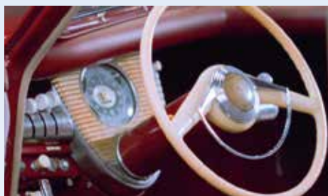
Dokonalost sama: Tucker 48 předstihl ty nejslavnější automobilky a jejich „objevy“ o desítky let – čalouněný střed volantu, čalouněné okraje přístrojovky, měkké obložení, k tomu bezpečnostní pásy!
