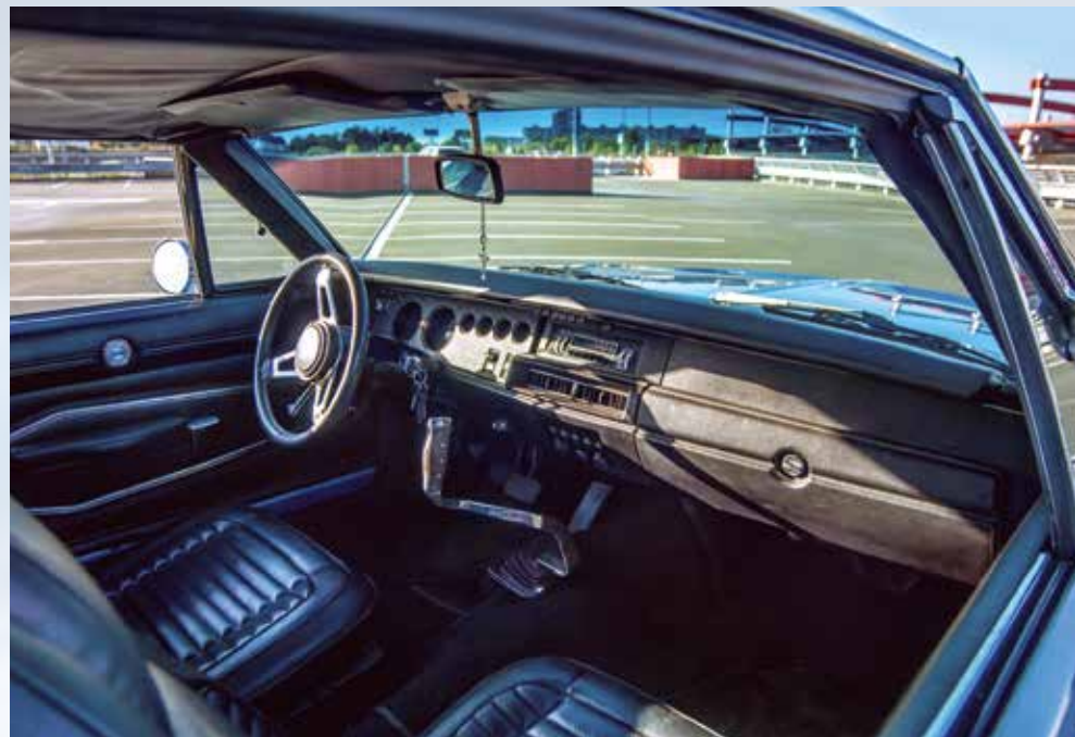
Zbyněk rozhodně není příznivcem automatiky. Proto také jeho Dodge nemá koncernový samočinný TorqueFlite, ale klasickou čtyřstupňovou převodovku s typickou pákou na středovém tunelu
