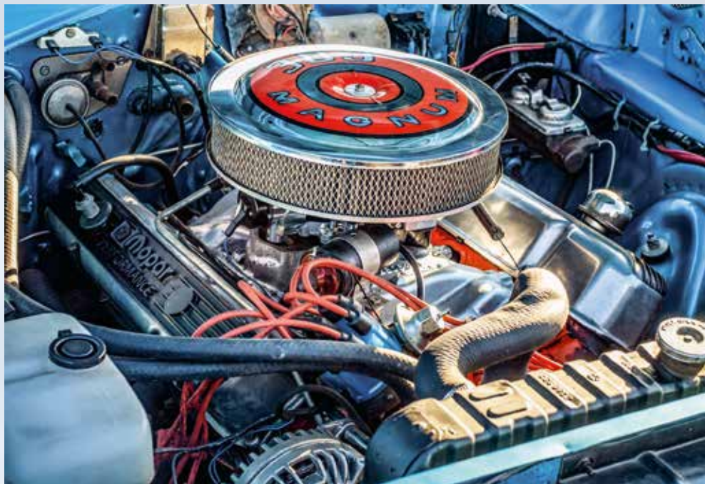
Motorový prostor se leskne jako před čtyřiapadesáti lety. V8 Chrysler Firepower 383 cu.i. dokáže mobilizovat 335 koní, ale majitel není z těch, kteří spálí dvoje obutí během jedné sezóny
