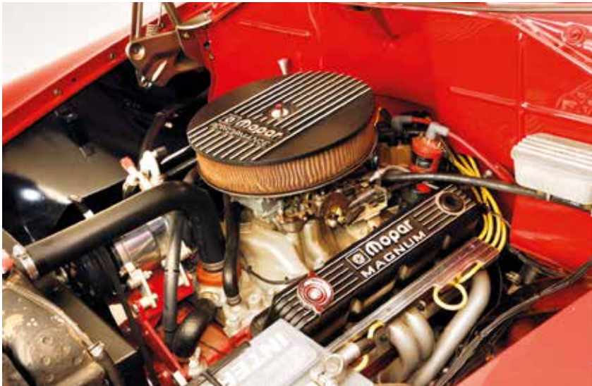
Nebyli by to hotroddeři, kdyby nechali pod kapotou původní jednoduchý agregát. Repliku osadili small-blockem Mopar 360 cu.i. s výkonem 300 koní!
