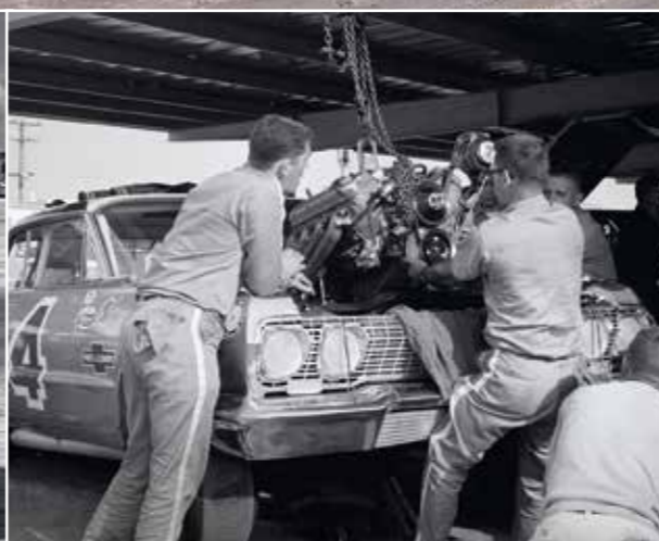
Počátkem roku 1963 Chevrolet připravil na ostrou zkoušku agregát V8 427 cu.i. Jeho síla se nedala s jiným výrobkem divize Chevy srovnávat. Dostal přezdívku „Mystery Motor“ a podařilo se jej naladit na výkon 540 koní. Na snímku Chevy Impala 1963 připravený Louiem Clementsem, řídí Rex White
