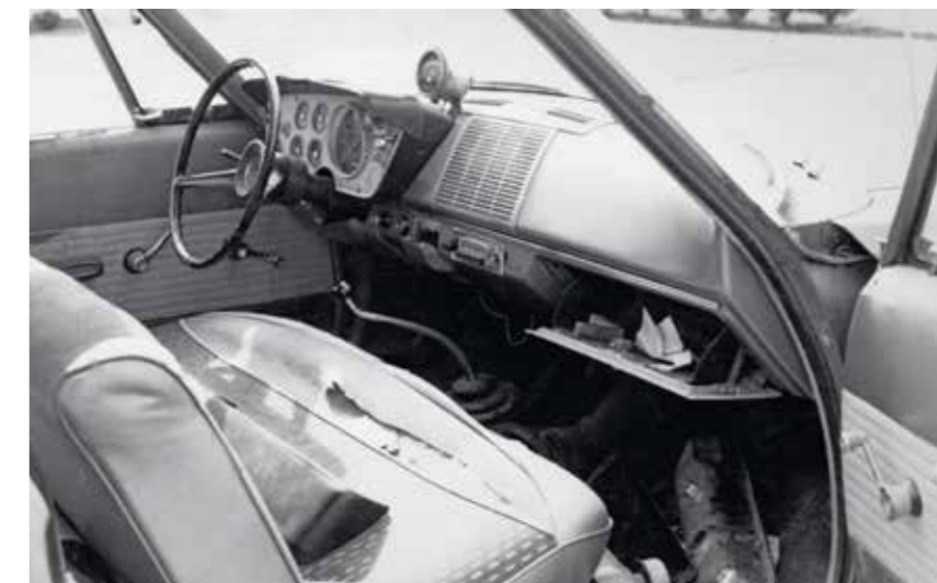
Během renovace zchátralého interiéru byly odstraněné nepůvodní a dodatečně montované doplňky, například rádio či otáčkoměr
