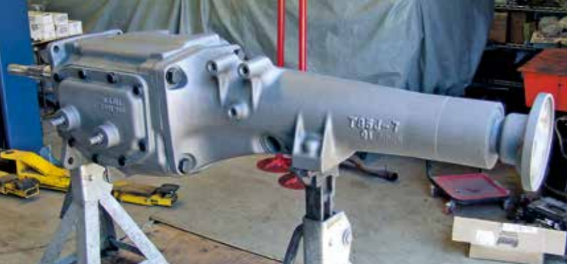
Později byly třístupňové převodovky často měněné za čtyřstupňové, tady se ale uchovává původní
