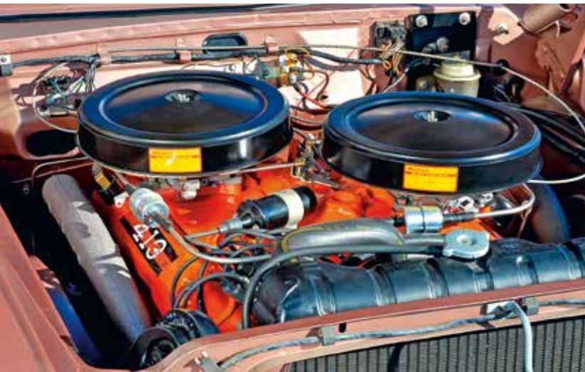
Díky kompresnímu poměru 11 : 1, mechanickým zdvihátkům, ostré vačce a sání Cross Ram se povedlo dostat z Max Wedge maximální výkon
