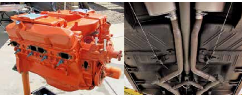
Oproti standardnímu V8 413 cu.i., používaném například v New Yorkeru, zvětšil výrobce u Max Wedge výfukové kanály o 25 %
