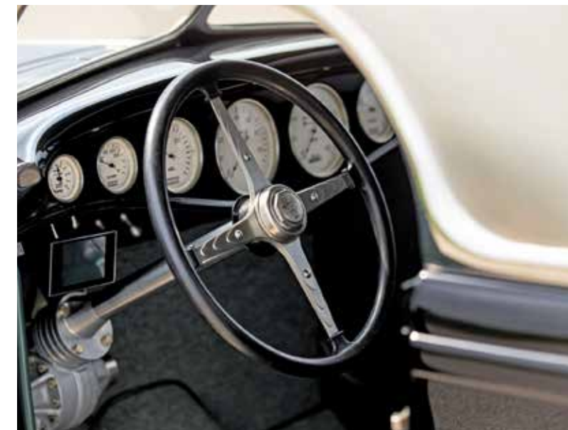
Za volantem s čtyřmi niklovanými příčkami vidí řidič řadu klasických přístrojů v centrálním uspořádání
