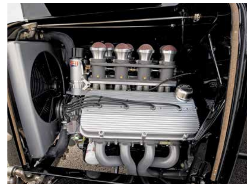
High-endová prototypová technika: experimentální V8 s čtyřventilovou technikou Hemi z programu Ford Racing vychází ze základu 302 cu.i.
