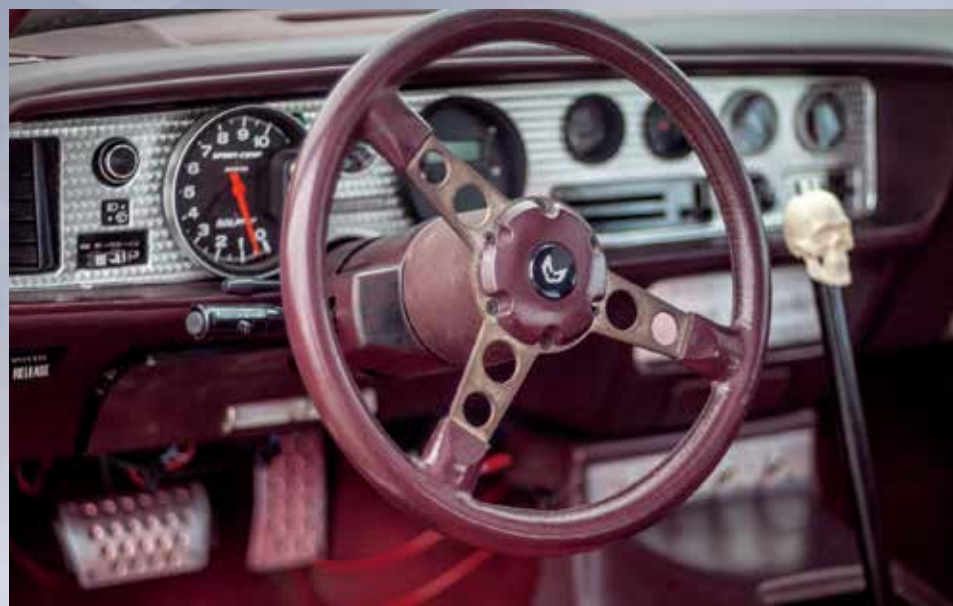
Interiér Blowerbirdu byl úmyslně ponechán v původní podobě. Přibyly pouze důležité přístroje jako otáčkoměr, cejchovaný teploměr vody a ukazatel bohatosti směsi
