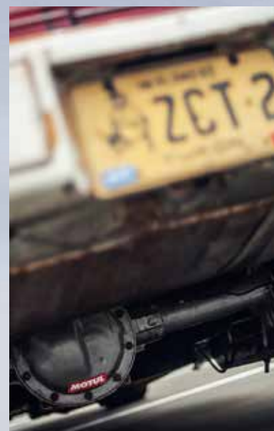
Samosvor z „kotoučové“ nápravy modelu Turbo dostal nová střeva. Přesto je nyní v linii pohonného ústrojí nejslabším článkem a v budoucnu se nevyhne upgrade
