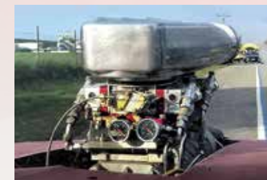
Na zadní straně karburátorů jsou řídičem za jízdy přehledně kulaté ukazatele tlaku motorového oleje a tlaku benzínu
