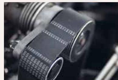
Šesticentimetrový drážkový řemen obstarává pohon kompresoru od klikové hřídele za pomoci kladky se silným napínákem
