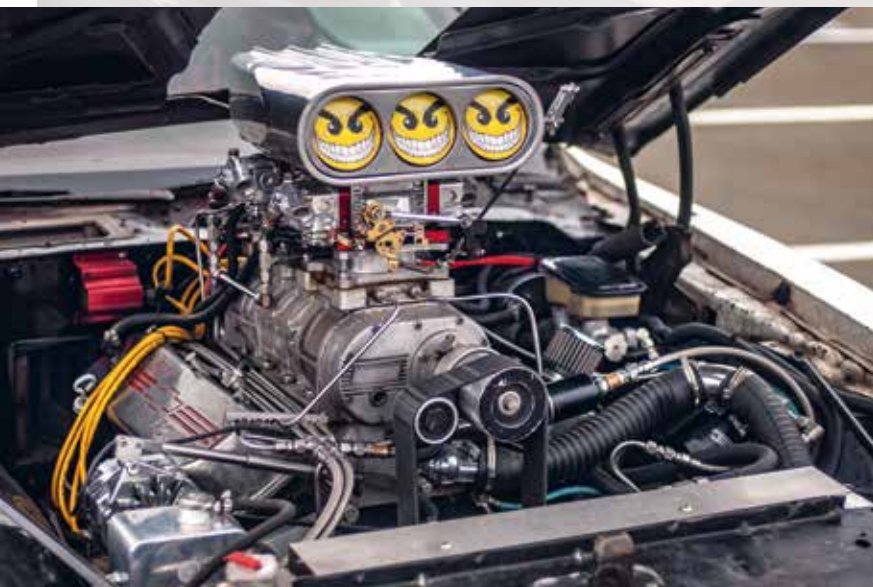
Dvourotorový Weiland prošel celkovou repasí, dvojice karburátorů Holley 800 cfm je nová a v tuto chvíli netrpělivě čeká na přísun palivové směsi
