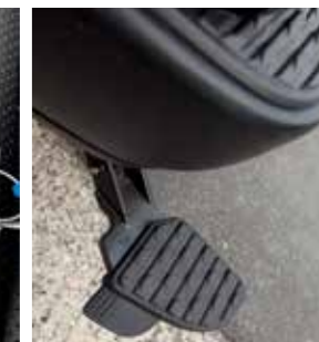
Jednoduše sklopný stupínek umožní pohodlnější nástup na korbu
