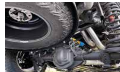
Zadní tuhá náprava Dana 60 je zavěšená na 5 bodech. Nezvyklým prvkem je podélný tlumič uchycený nad diferenciálem
