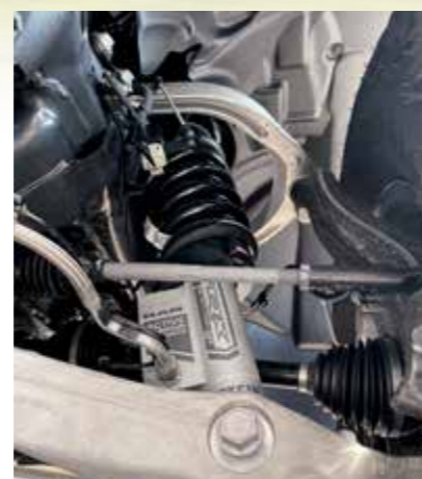
Kovaná hliníková ramena přispívají k robustnosti přední nápravy, která je konstruovaná pro hluboký ponor
