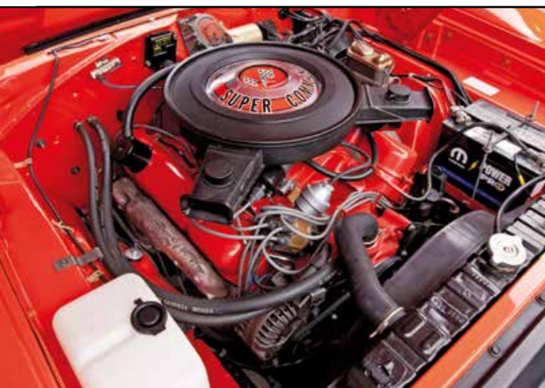
Ostré závodní modely používaly výhradně sedmilitrové osmiválce Hemi, zájemci o silniční provedení si mohli vybrat mezi třemi agregáty
