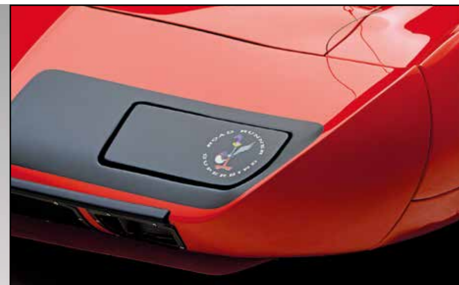
Špičatý nástavec je vyrobený z kovu, prohlubně světlometů a kryty jsou ze skelných vláken
