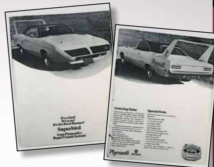
Špičatý nástavec je vyrobený z kovu, prohlubně světlometů a kryty jsou ze skelných vláken
