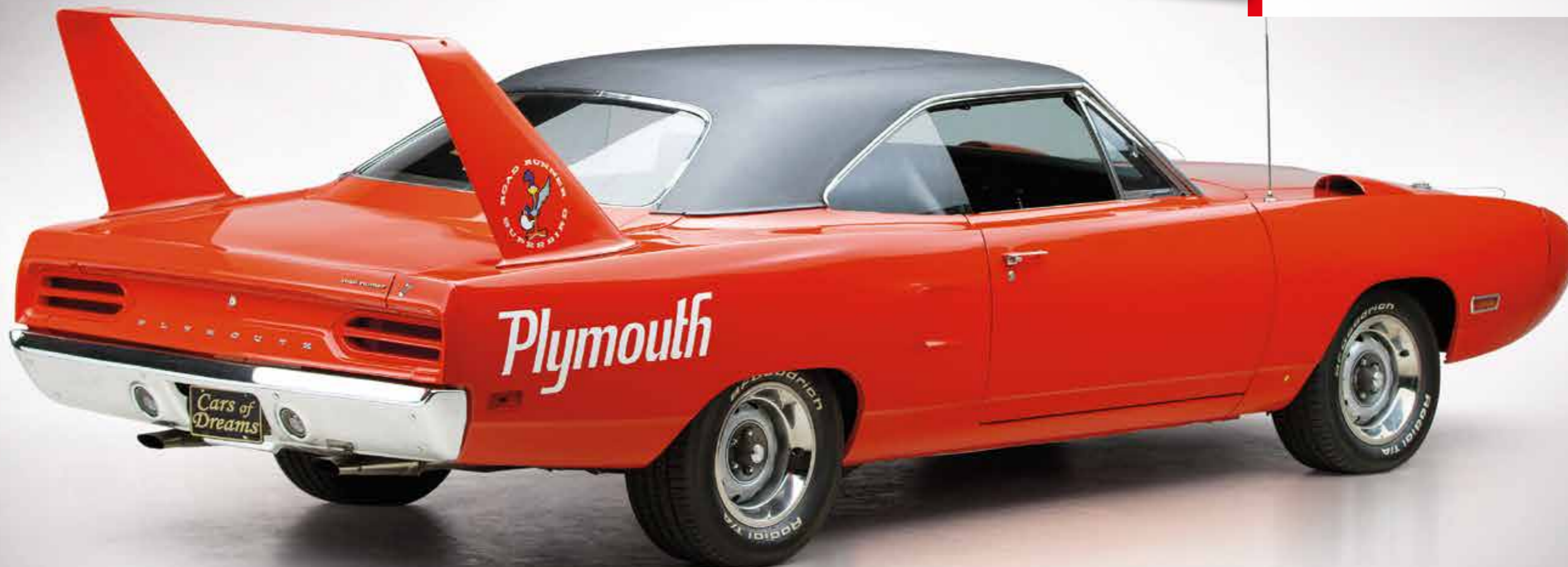
Všechny sériové Superbirdy měly křiklavé odstíny „High Impact Colors“, vinylový střešní potah a aerodynamické zadní sklo
