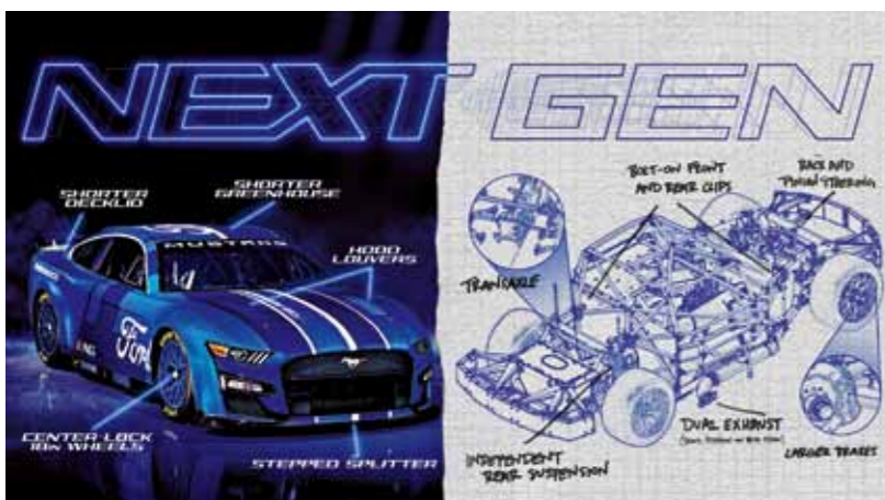
Na této skice je vidět trubkový rám, který se v ničem nepodobá sériovému šasi
