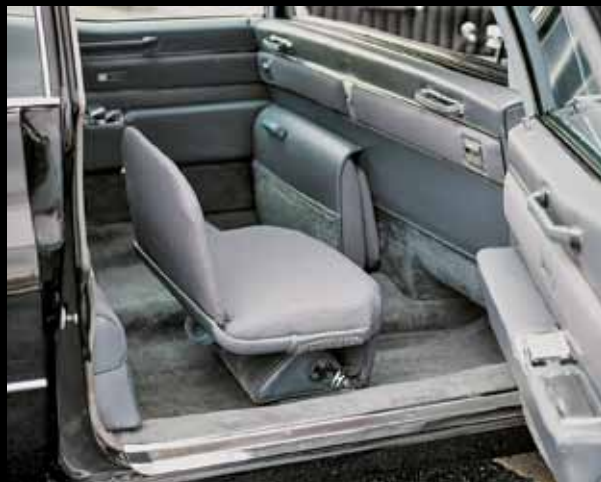
Před dělicí stěnou jsou sklopená nouzová sedadla. Po jejich vyklopení vzroste kapacita až na devět cestujících
