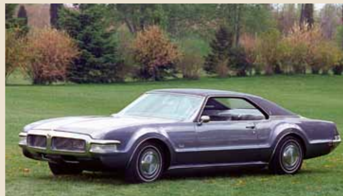
V roce 1969 se pohledy veřejnosti soustředily na markantní před, tvořenou rozměrným chromovaným rámem, rozděleným v polovině svislým žebrem. Světlomety se objevily uvnitř rámu
