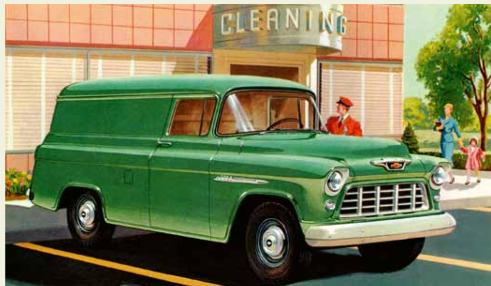
Panel vany si často pořizovaly průmyslové prádelny a čistírny. Na snímku je před fiktivní budovou Chevrolet Panel Truck modelové řady 3105 z roku 1955, poháněný šestiválcem Thriftmaster 235,5 cu.i.
