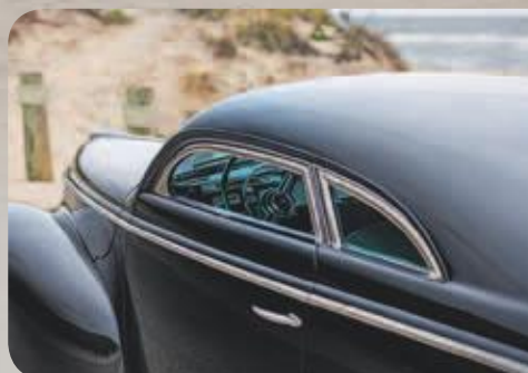
Top Chop si vynutil novou konstrukci a výrobu okenních rámců i skel
