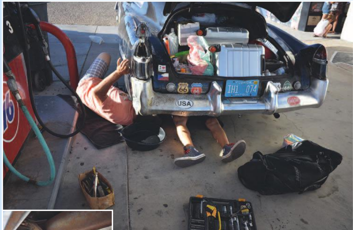
Nebojte, nikoho jsme nepřejeli! Ty nohy patří Márovi, který právě napojuje nový kus palivové hadice. „Doctor“ se prostě rozhodl, že do té Kalifornie nechce a dává nám to stále víc a víc najevo...
