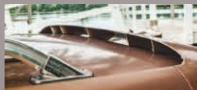
Střešní nástavec výrobce pojmenoval „Chrysler's Revolutionary Airfoil“. Pokud je otevřené okno v pátých dveřích, stará se o odsávání vzduchu z interiéru, pokud je zavřené, odklání proud vzduchu s nečistotami
