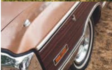
Když se chromy setkají: silná lišta, lemující horní stranu „fládrované“ plochy těsně přiléhá k postranní špičce „brejlí“. Pod ní boční parkovačka a pak už jen kolo, krásné tak, jak dokáže být jen původní součást vozu
