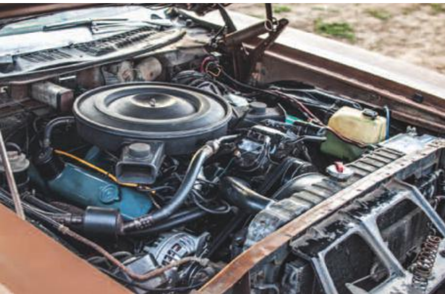
Osmiválec 383 cu.i. dodává 335 koní i když vypadá docela mírumilovně. Ale zdání klame... Pod velkým krytem vzduchového filtru trní čtyřkomorový Carter, který prošel spolu s ostatní technikou náročnou repasí
