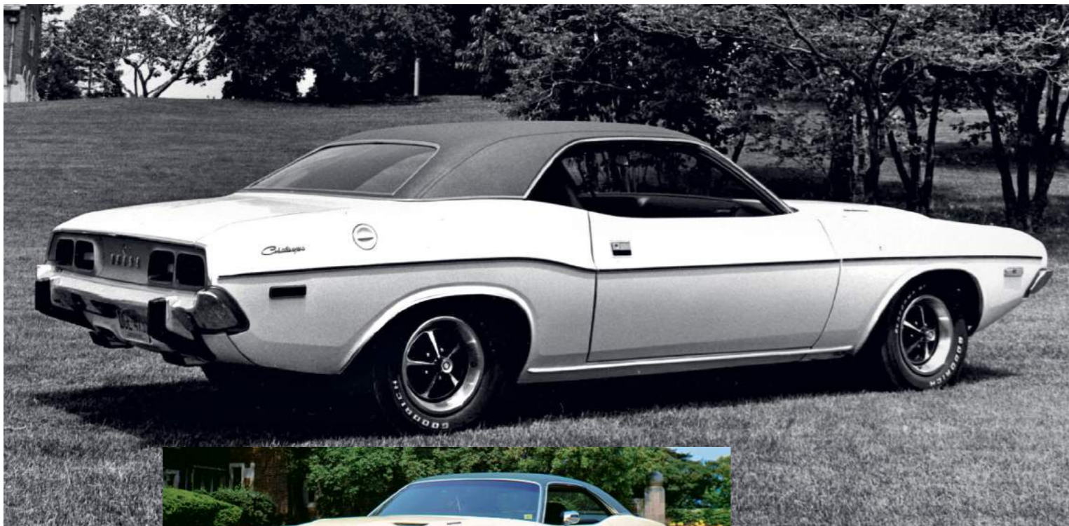
V roce 1973 musel i Challenger vyhovět novým bezpečnostním předpisům, takže se na náraznících objevily obří svíslé členy osazené gumovými bloky
