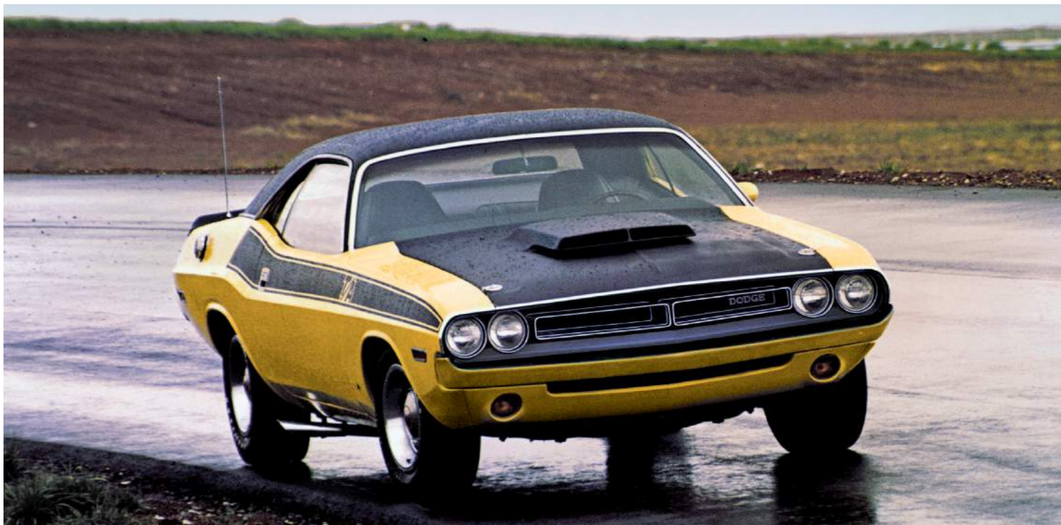
Homologace Challengeru T/A do podniků série Trans America vyžadovala výrobu určitého počtu shodných modelů, osazených osmiválcem 340 cu.i. Six Pack a převodovkou A-833
