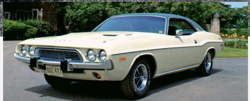
V roce 1973 musel i Challenger vyhovět novým bezpečnostním předpisům, takže se na náraznících objevily obří svíslé členy osazené gumovými bloky
