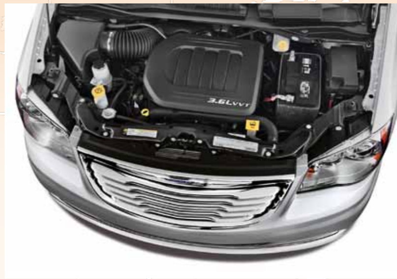
Povedený motor V6 Pentastar o objemu 3,6 litru se dodával v několika výkonových stupních a představoval špičkovou alternativu pod kapotu minivanu. Majitelé si chválí jeho zátaž i příjemnou spotřebu. Čas ukáže jestli bude mít podobnou výdrž jako předchozí 3,3 a 3,8 litrové věšestky
