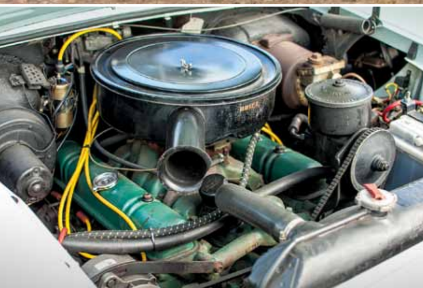
Šestilitrávná véosmička slavila u ročníku 1957 premiéru. Říká se jí „Nailhead“ a patří k legendárním strojnám Buicku. Pod kapotami vydržela čtyři roky
