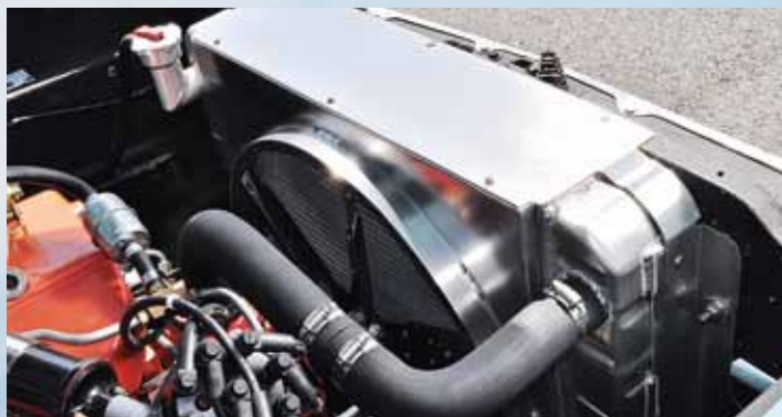
Třířadý hliníkový chladič dokáže i v těch největších vedrech udržet provozní teplotu velkoobjemového agregátu v normálu
