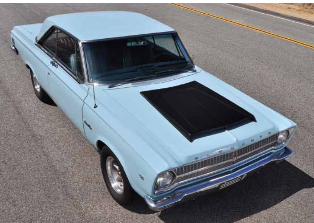
Plastový scoop je napodobenina původního A-990, používaného v roce 1965 u Super Stock Drag Cars
