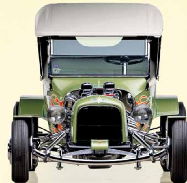
Zkrácený grill ročníku '32 je přizpůsobený nízkému a úzkému vzhledu původní přídě „Těčka“ 1916
