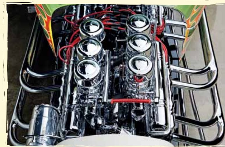
Ukázkou mechanické zručnosti je osazení motoru šesti karburátory Holley „94“ a sáním Weiland
