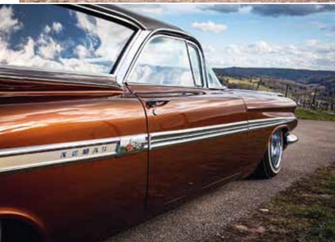
Původní střešní sloupky B mají elegantní náklon dopředu a přidržují bezrámová okna dveří, pocházející původně z Impaly kupé 1959
