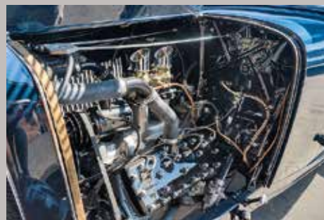
Spodová véosmička Mercury je osazená dvojicí karburátorů Stromberg
