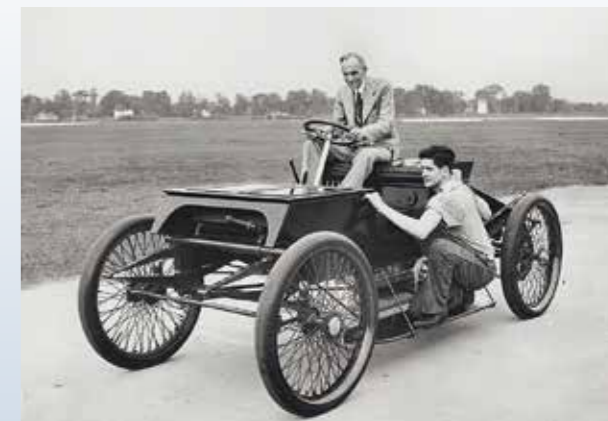
Ford „Sweepstakes“ se naprosto nepodobal ostatním vozům své doby. Nebyl sice aerodynamický, ale konstrukčně přizpůsobený k dosažení nejvyšší možné maximálky
