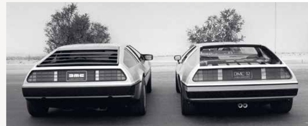
Na snímku dvojice prototypů v různém stádiu: prototyp vlevo je už prakticky zralý do výroby, dostane ještě nějaké kosmetické úpravy a drobné změny v doplňcích. Vpravo je mezityp, na němž byla ověřovaná různá designová řešení, proto se na první pohled odlišuje od série
