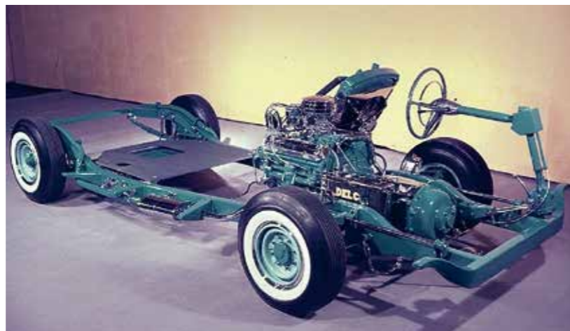
■ Kvalitní snímek samotné mechanické skupiny: převodovka je před motorem na nápravě (tedy transaxle), určitě zajímavý a netradiční je skloněný chladič v horní části. Řízení asi chtělo trochu cviku...
