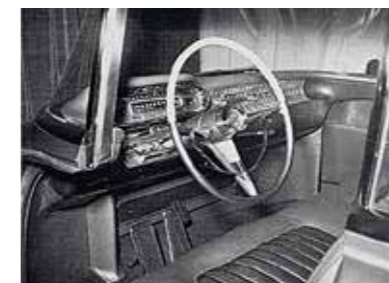
■ Sdružený přístroj je sice jednoduchý, zato podle tehdejších možností vybavený bezpečnostními prvky, ale navíc efektní: celý zářil podobným odstínem jako karosérie
