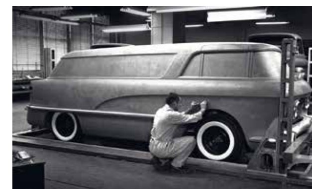
■ Celkový vzhled nového GMC je hotový, nyní zbývá doladit poslední plošky, ale hlavně hliněný model osadit ozdobami a detaily. Jde o hodně: o samotné schválení do série...
