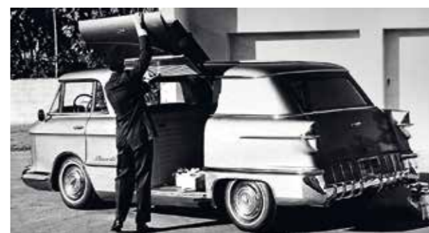
■ Trojice snímků reklamního oddělení představuje zajímavou konstrukci nůžkových dveří. Ty boční by v těsných ulicích asi nebyly nejlepším řešením a kdoví, kolik cyklů otevření/zavření by vlastně vydržely
