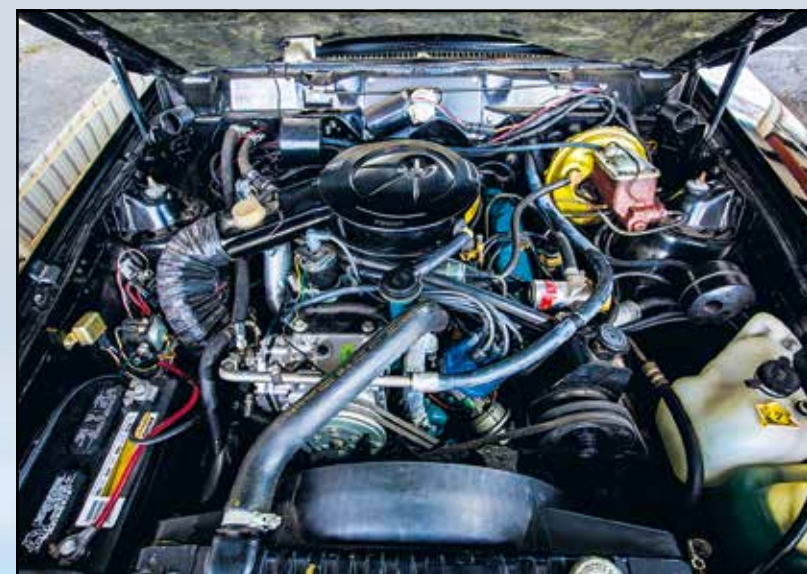
Srdcem AMX je vósmička 304 cu.i. s příplatkovou klimatizací, servořízením a tempomatem
