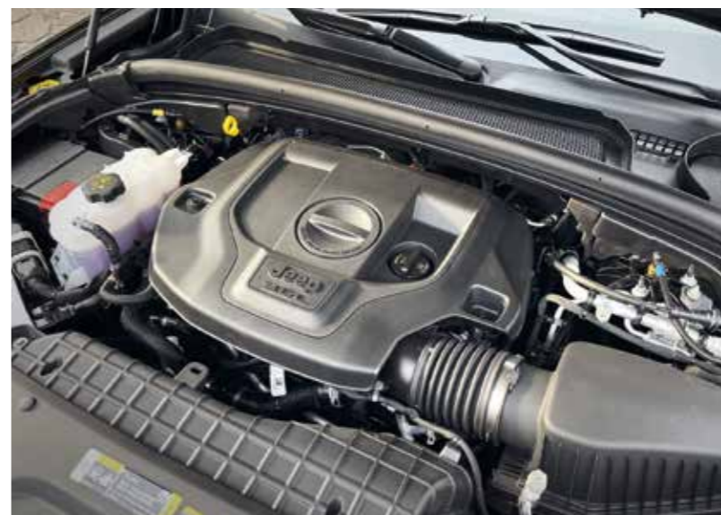
Vidlicový šestiválec Pentastar 3.6L s proměnlivým časováním ventilů disponuje výkonem 293 koní a spolupracuje s osmistupňovým automatem
