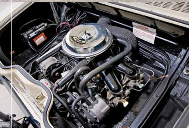
V zádi trůnil plochý šestiválec, což se negativně projevilo v rozložení hmotnosti
