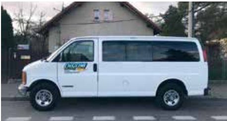
Chevrolet Express 2500 Heavy Duty ročníku 2000 v dlouhodobém „testu“ naší redakce. Kombinace Vortecu 5.7L, převodovky z Humeru H1 a velké nápravy se samosvorem z něj dělají nezničitelný stroj
