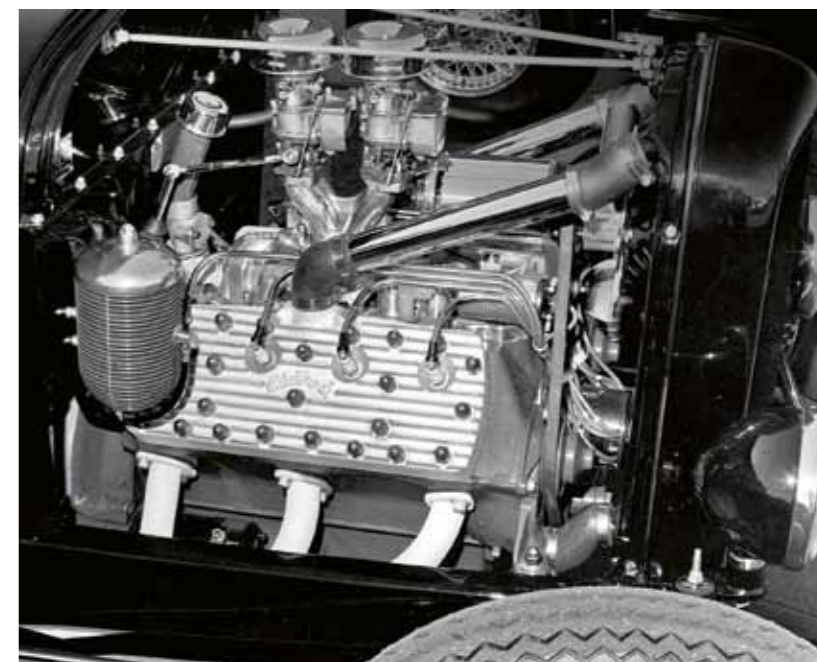
Slavná véosmička Ford Flathead opatřená Edselbrockovými hlavami a dalším příslušenstvím. Na počátku byla jeho pojízdná „laboratoř“, s níž počátkem 40. let dosáhl rychlosti více než 120 mph!
