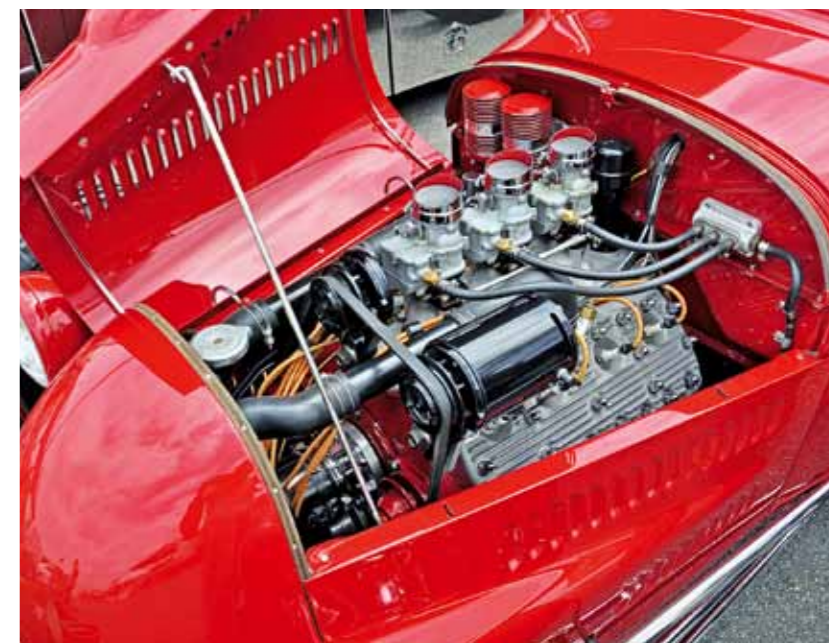
Během renovace se opět pod kapotou objevil převrtaný flathead Ford – přesně takový, jaký tam měl Dick Flint
