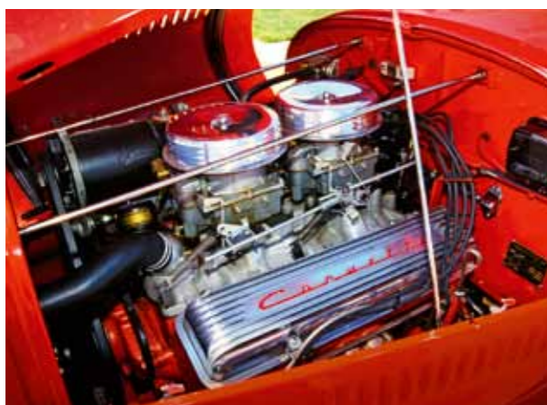
Replika roadsteru je osazená véosmičkou Corvette 283 cu.i., podobně byl originál přestavěný druhým majitelem
