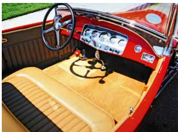
Podlahové plechy montované na rámu a channeling karosérie dávají ztisněný, ale zcela rovný prostor pro nohy
