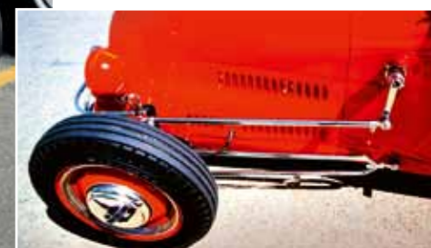
Jak je u Sprint Cars zvykem, pohyby volantu se přenášely na tyč řízení, umístěnou vně karosérie
