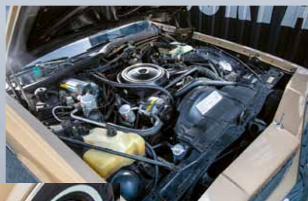
Žádný trhač asfaltu, ale klasická véosmička 307 cu.i. „Rocket“ se slušným zátahem a tradiční spolehlivostí
