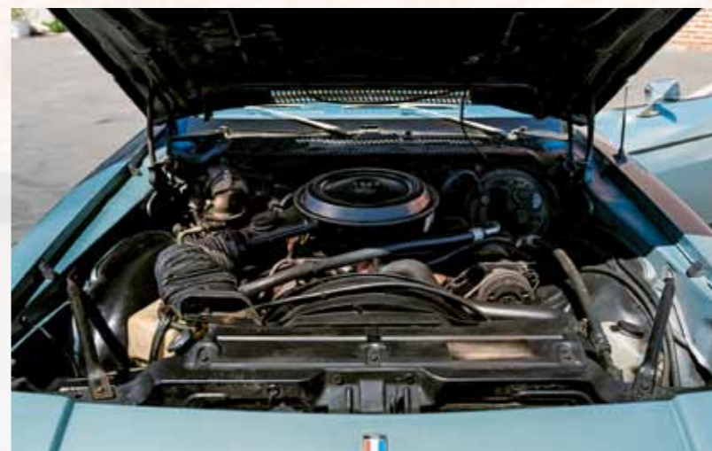
Pod kapotou vše při starém! Véosmička 350 cu.i. byla tehdy nejsilnější motorizací a dává hodně redukováný výkon 165 koní
