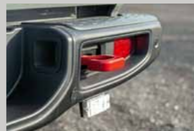
Robustní tažná oka v náraznících jsou praktická. Najdete je ve dvojicích vpředu i vzadu. Přídavná mlhovka se v terénu dlouho neohřeje...
