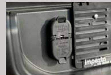
Gladiator utáhne trailer o váze 2.041 kg. Vedle běžné zásuvky má i americký T-konektor pro připojení příslušenství
