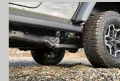
Zadní tuhá náprava s dvojitými vlečenými rameny skýtá pohodlí i zajímavé možnosti v terénu
