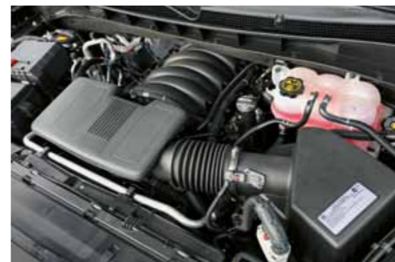
Srdcem vozu zůstává atmosférický benzinový osmiválec 6.2L o výkonu 420 koní. Agregát je v porovnání s předchozí generací posunutý dozadu a má před sebou větší „bezpečnostní“ zónu
