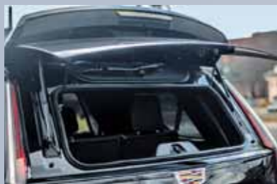
Zadní víko otevřete stlačením loga Cadillaku. Jednou z možností je vykloupat vzhůru samotné sklo, zatímco víko zůstává zavřené. Chytré a praktické řešení při nákupu!
