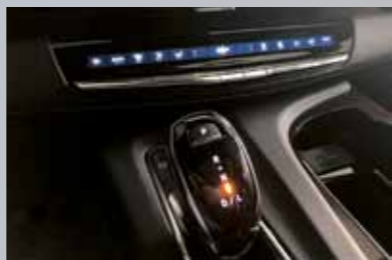
Přestože obrovský displej nabízí levnější řešení, Caddy si zachoval hardwarová tlačítka nejčastěji používaných funkcí. Bezpečnostní prvek, tolik opomíjený u evropských vozů
