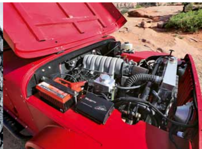
Yeah, a pod kapotou je Hemi! V tomto případě s objemem 370 cu.i. a výkonem 425 koní
