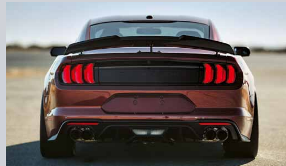
Aktivní elektricky stavitelné křídlo z uhlíkových vláken je výhradní specialitou Jack Roush Edition Mustangu
