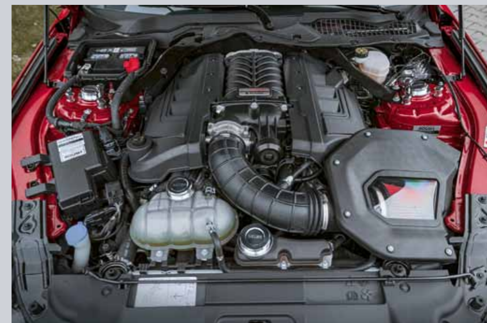
Supercharger Roush Phase3 proměnil už tak plnokrevný osmiválec v ultimativní strojovnu disponující výkonem 775 koní a točivým momentem 910 Nm!
