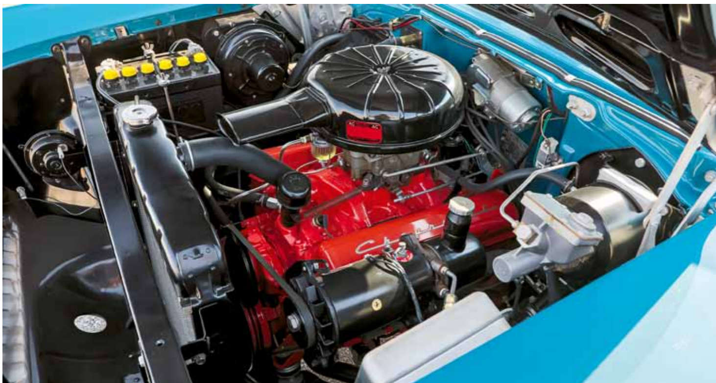
Pohon modrého kabria zajišťuje small-block V8 283 cu.i.
