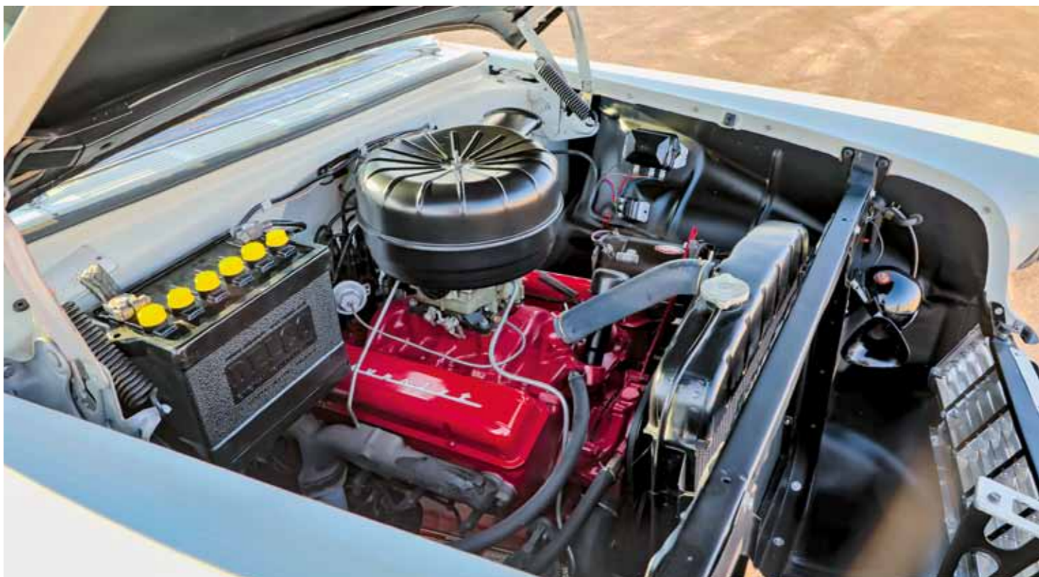
Pod bílou kapotou dání small-block Chevy V8 265 cu.i., korunovaný čtyřkomorovým karburátorem
