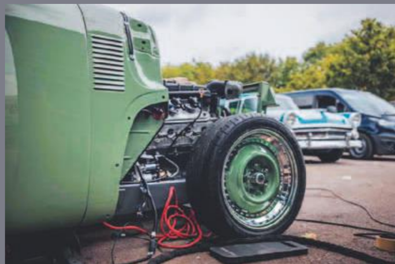
Nákladáček roluje na dvoudílných ráfcích: k původním středům Chevy jsou přišroubované precizně vyleštěné 17palcové věnce. Efekt je dokonalý!
