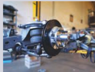
Přední brzdy jsou kotoučové, vzadu má pickup přestrojené bubny. Klasické pružiny ustoupily vzduchovým měčům
