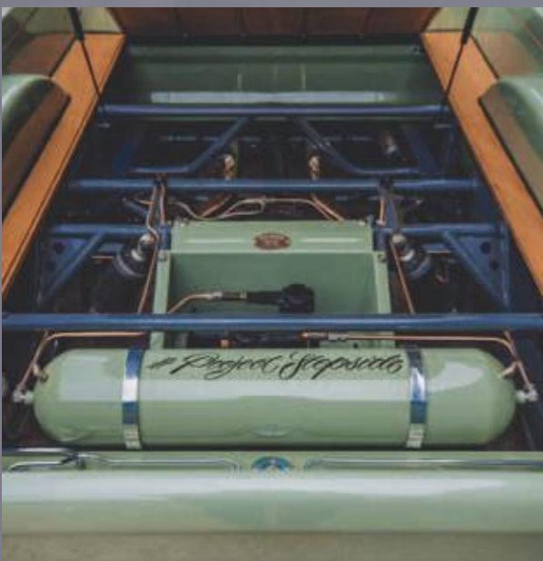
Pod zvednutou ložnou plochou je možné obdivovat zásobník vzduchu pro měchy podvozku
