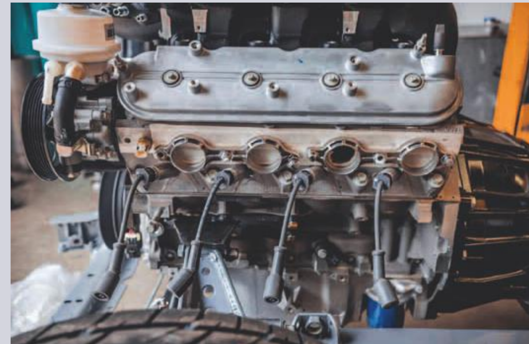
Pod kapotou Stepsidu trní osmiválcový small-block LS3 dopovaný kompresorem Edelbrock E-Force. Výkon 500 koní se zdá být dostačující. Supercharger potřebuje opravdu hodně vzduchu...
