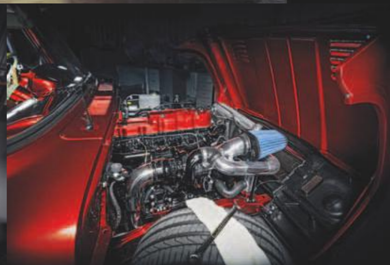
325koňový Cummins o objemu 359 cu.i. je solidní držák: první generádku má plánovanou až po 350.000 milích!
