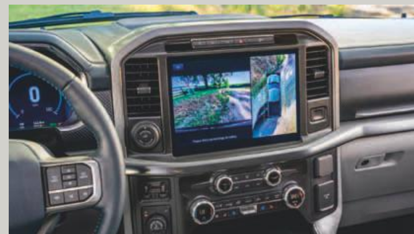
Architektura palubní desky navazuje na předchozí model. Nově je k dispozici infozábranní systém SYNC 4. generace s dvakrát rychlejším procesorem a možností víceokenného zobrazování
