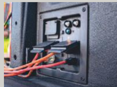
Ovládání a výstupy integrované elektrocentrály (až 7,2 kW) jsou umístěny na praktickém místě uvnitř korbey
