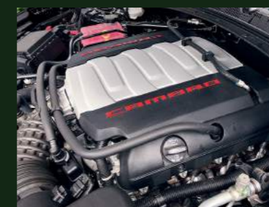
Celohliníkový jednoválcový osmiválec s dvouventilovou technikou už v evropských autech nenajdete. Amerika je našťastí jiná a spolehlivý small-block stále nabízí
