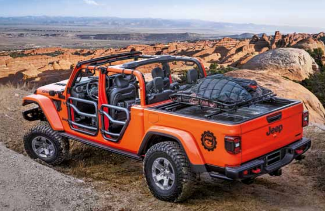
Příčnický nosič přes ložnou plochu umožňuje namontovat například nosič na jízdní kola
