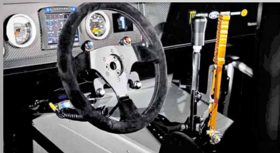
Tak tady „pracuje“ Ken Block: sedačka Recaro s výhledem na karbonovou přístrojovku a tříramenný volant. Na středovém tunelu nelze přehlédnout radičku a páku brzd s autobusáckými rozměry
