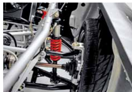
Firma Detroit Speed přestavěla klasický pickup na šasi s trubkovým rámem
