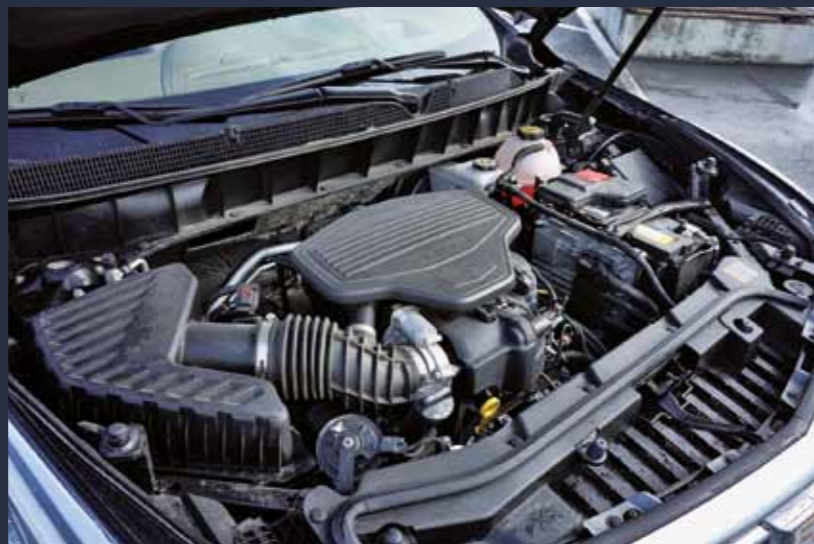
Benzinový šestiválec 3,6 litru disponuje výkonem 314 koní a umí automaticky odpojovat dva válce. Ani poté neztrácí svou kultivovanost a navíc překvapí příjemnou kombinovanou spotřebou
