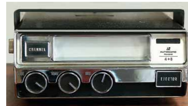
■ Portable Eight-Track Player – i tak to šlo, alespoň zpočátku, kdy se celý přehrávač zasunul pod přístrojovou desku. Součástí výbavy se stal nejdříve u dražší produkce, pak se rozšířil do všech tříd
