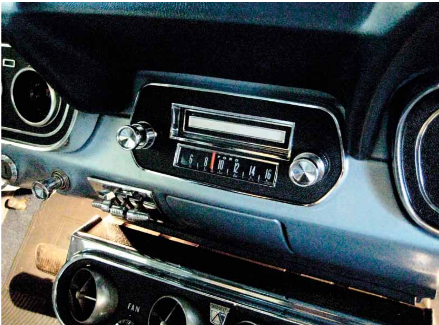
■ Obvyčejný rádiopřijímač s jedním pásmem a nad ním kazetová šachta osmistopého přehrávače. Dole pod přístrojovkou klimatizace – a víc zařízení jste k cestě „Coast to Coast“ nepotřebovali
