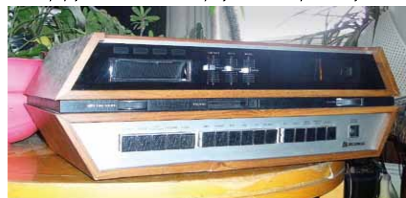
■ Domácí provedení osmistopého přehrávače bylo robustní a rozměrné, navíc doplněné rozhlasovým přijímačem. Na něco takového by zřejmě leckdo nechápavě koukal ještě dnes...
